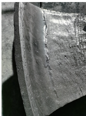
图3：现场衬板上部有明显挤压
