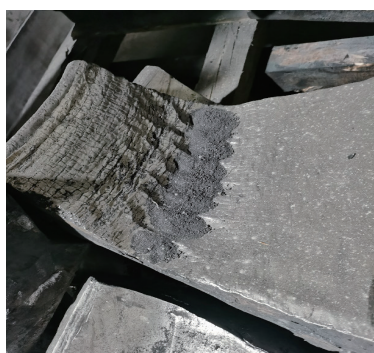
> 图4：现场衬板内侧有明显挤压
