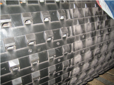
>图1 转子污染示意图
