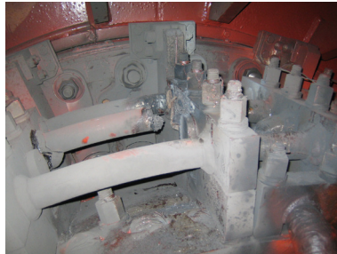
>图2 并联环损坏示意图
