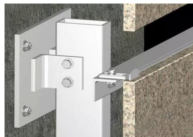
图 3-2 预制装配式龙骨实景图
