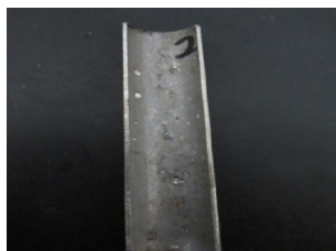
图1 热网加热器管宏观形貌图
