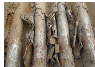
图2 热网波纹管腐蚀破裂局部形貌
