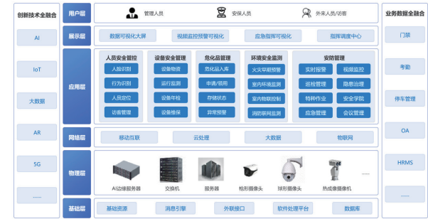
图11 智能视频分析平台系统架构
