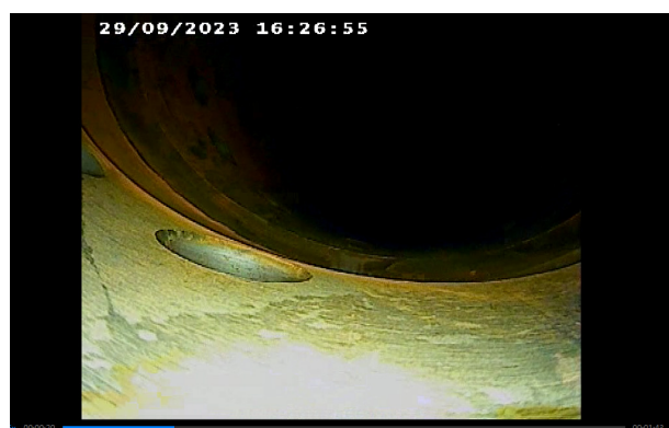
图6 锅炉吹管后低压高再集箱10屏开孔处内窥镜情况
