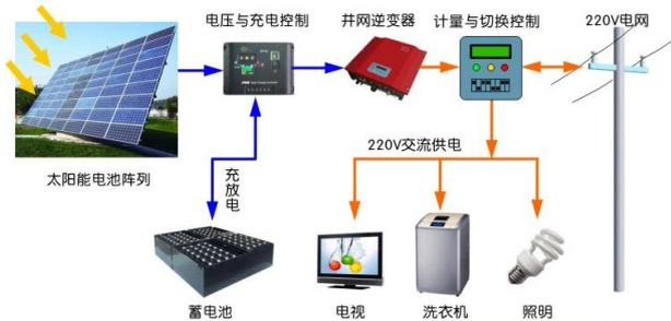
>图1：分布式光伏发电系统
