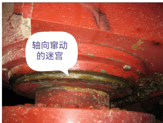
> 图1 斗轮轴承座迷宫密封轴向窜动的图片
