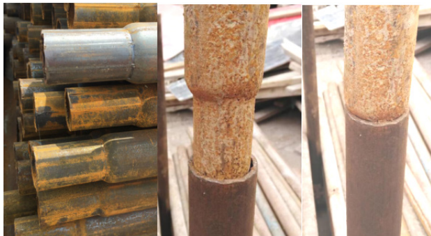
> 图 2 支撑杆连接示意图
