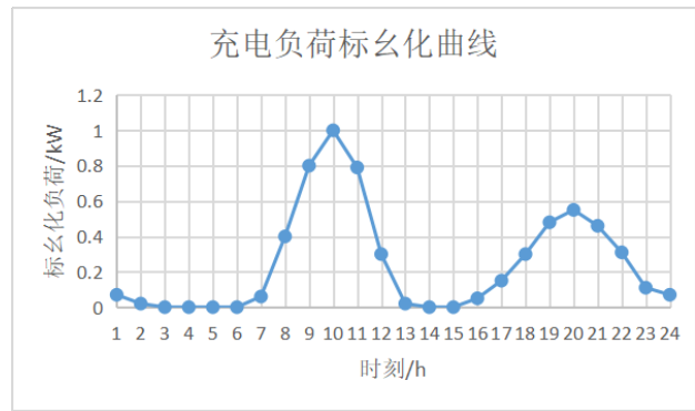
> 图3 大工业用户充电桩充电负荷标么化曲线
