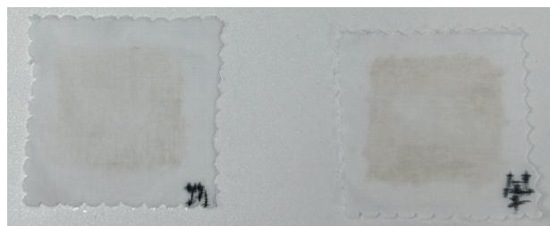
图3 未经过细菌培养（左）与经过细菌培养（右）的巧克力布丁污渍洗涤后残余污渍量的比较
