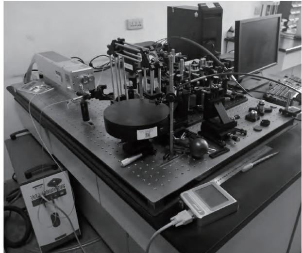
> 图2实验室 LIBS 装置实物图
