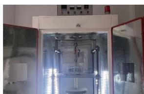
>图2 温控磨光机实物图
