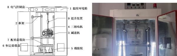
>图1 温控磨光机示意图
