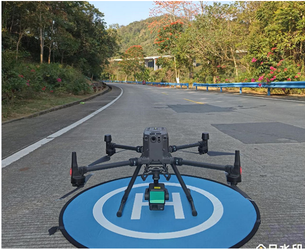
图4 大疆 Matrice 300 RTK 搭载禅思 L2
