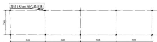
图2 方案1的单个组串支架基础布置图(推荐采用)
