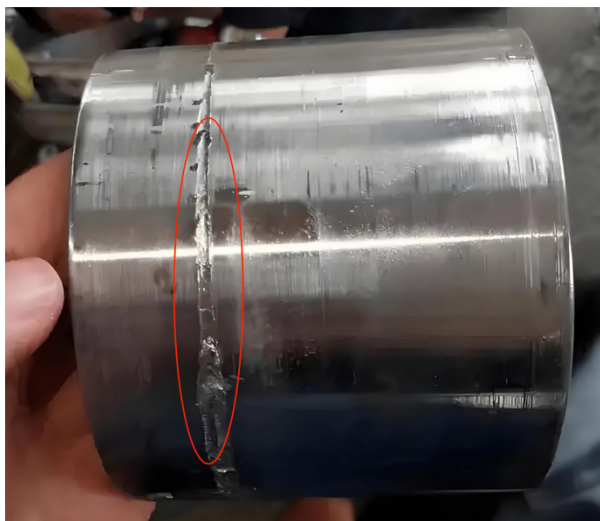
图1 轴承外部磨损
