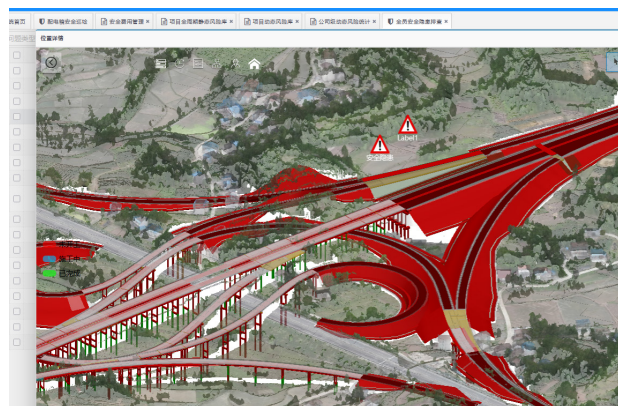
图9 基于 BIM+GIS 的施工质量管控
