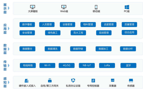
图1 雄忻高铁智慧工地 '1+3+N' 技术架构图 "
