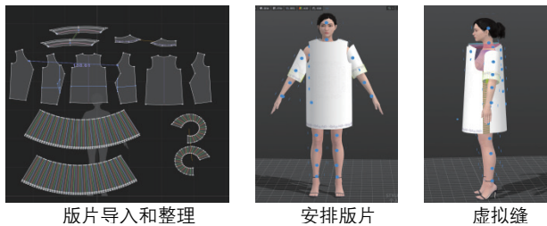
图3 蓝印花布服装数字化虚拟缝制
