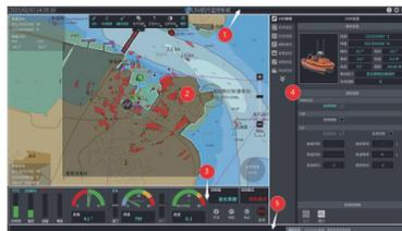
图 3-3 无人船显控软件界面示意图
