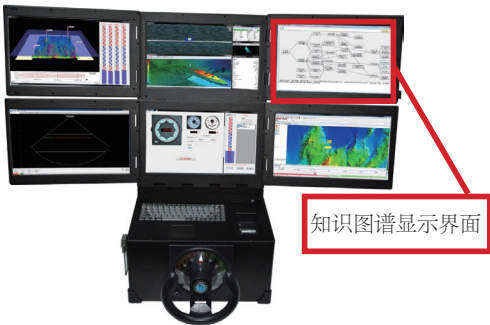
图6内嵌知识图谱的海道测量仿真教学平台外观
