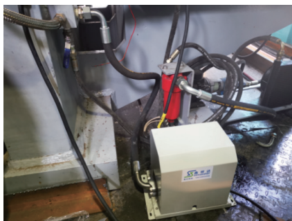
图2 油液、磨损传感器安装点位 [3]
