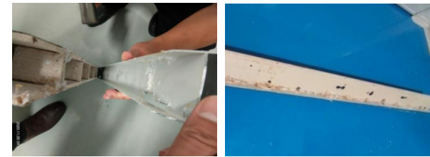
图2-1 T2401房间门板的内层板材（玻镁板）
