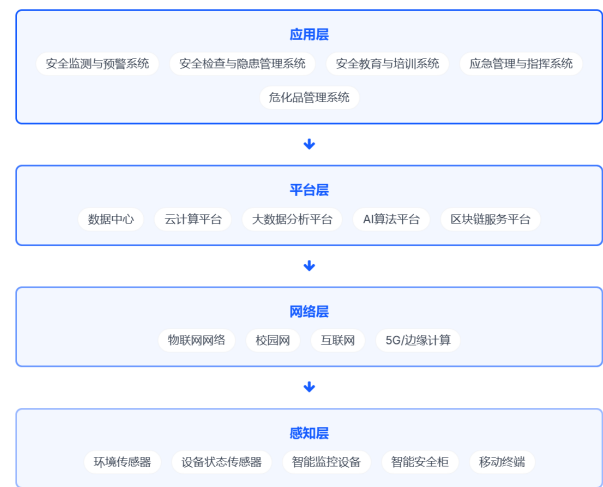
图2 实验室安全管理信息双循环系统架构
