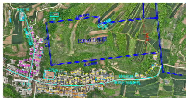
图1: 地表村庄及重要建(构)筑物测站布置示意图
