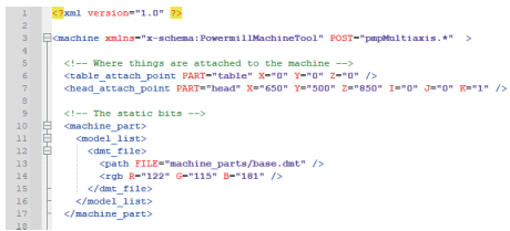
图 3 Makino V80S 仿真机床 MTD 文件
