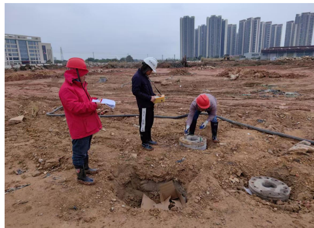
图3 桩身完整性（低应变）检测
