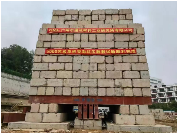
图2 单桩竖向抗压静载试验图
