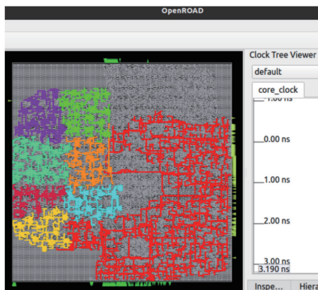
图2 RISC-V 微处理器在 OpenROAD 工具中的时钟树版图
